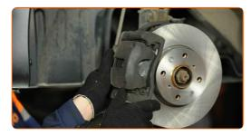
Utilizza una chiave combinata N°15. Utilizza una chiave a bussola N°13. Usa una chiave dinamometrica. Serralo fino allo coppia di torsione di 35 Nm.
