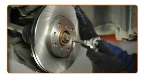
Pulire il sostegno pinza freno da sporco e polvere. Usa una spazzola metallica. Usa un pulitore freni.
