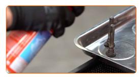
Tratta i perni guida della pinza del freno con il prodotto. Usa il grasso per il perno guida della pinza del freno.
