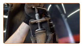
35.1 Montare la pinza del freno e fissarla.
