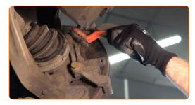
Svitare l'attacco della staffa pinza freno. Utilizza una chiave a bussola N°17. Usa un giramaschi. Usa una chiave a cricchetto.
