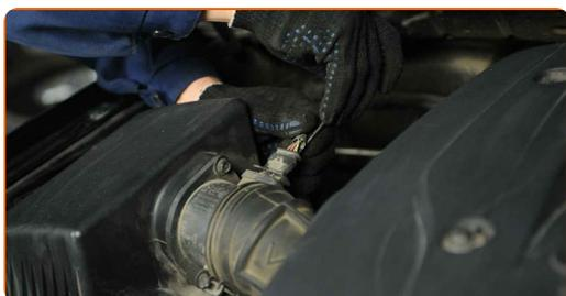
**21** Allenta i morsetti di fissaggio che collegano il condotto dell'aria alla scatola del filtro dell'aria. Usa un cacciavite Phillips.
