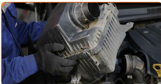
**49** Connetti il tubo di aspirazione del compressore all'alloggiamento del filtro dell'aria.
