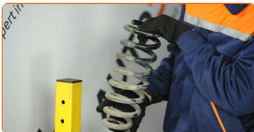
**37** Rimuovi il parapolvere e il paracolpi dell'ammortizzatore.
