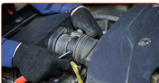
**23** Scollega il collare di fissaggio del tubo di aspirazione. Usa un cacciavite Phillips.
