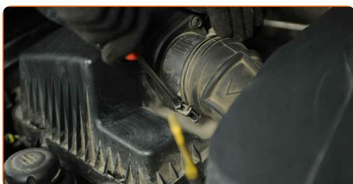
**22** Scollega il tubo di aspirazione del compressore dall'alloggiamento del filtro dell'aria.
