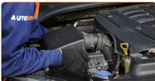
**50** Collega il tubo di aspirazione dell'aria all'alloggiamento del filtro dell'aria.
