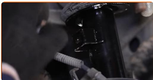
**13** Pulisci gli elementi di fissaggio del puntone dell'ammortizzatore. Usa una spazzola metallica. Usa lo spray WD-40.
