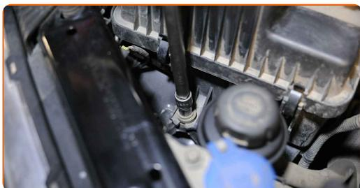
**48** Montare la carcassa del filtro d'aria.
