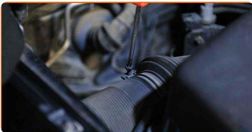
**24** Scollega il tubo di aspirazione dell'aria dall'alloggiamento del filtro dell'aria.
