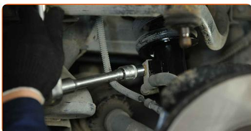
**12** Scollegare la staffa di fissaggio del tubo flessibile del freno.
