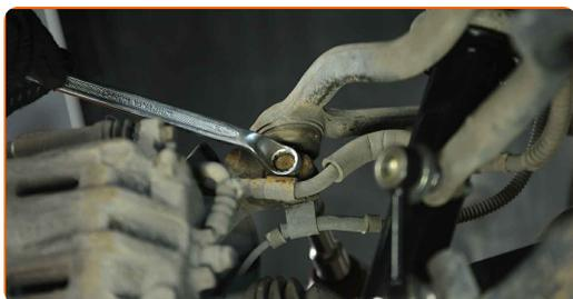
**7** Scollegare il cablaggio del sensore ABS.
