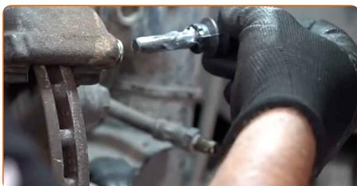
**28** Pulisci gli elementi di fissaggio del supporto pinza freno. Usa una spazzola metallica. Usa lo spray WD-40.
