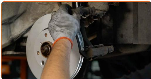
**31** Monta i bulloni di fissaggio (2 pezzi).
