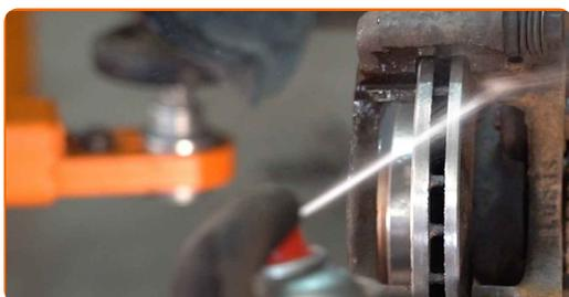
**29** Tratta gli elementi di fissaggio del supporto pinza freno. Utilizza un sigillante.
