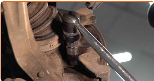
**15** Rimuovi i bulloni di fissaggio (2 pezzi).
