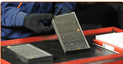
**6** Rimuovere dall'alloggiamento del filtro l'elemento filtrante da sostituire.
