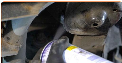
**43** Installa la molla elicoidale insieme ai montanti di gomma nelle sedi di montaggio.
