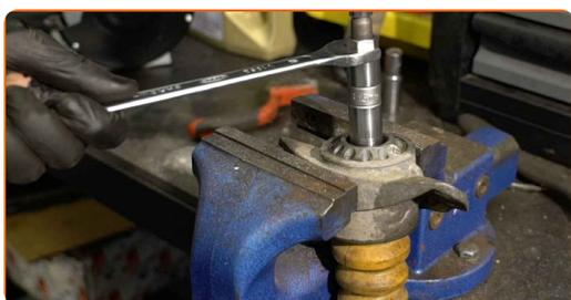
**30** Tratta con del prodotto l'elemento di fissaggio della bielletta dell'ammortizzatore. Usa il grasso al rame.
