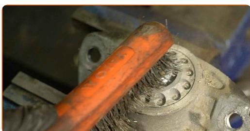
**26** Rimuovere l'elemento di fissaggio dell'asta pistone ammortizzatore. Usa la chiave a bussola per ammortizzatore DDN°6. Utilizza una chiave a bussola N°17. Usa una chiave a cricchetto.
