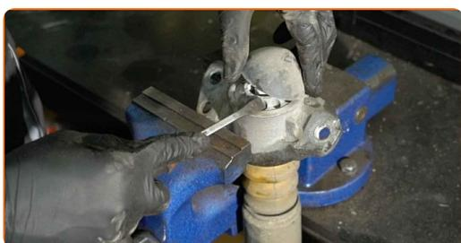
**25** Pulisci l'elemento di fissaggio dell'asta dell'ammortizzatore. Usa una spazzola metallica. Usa lo spray WD-40.
