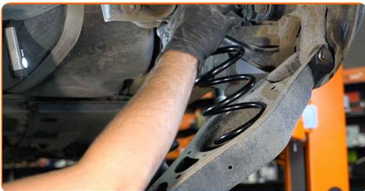
**44** Pulisci le sedi di montaggio e la filettatura del braccio di sospensione. Usa una spazzola metallica. Usa lo spray WD-40.
