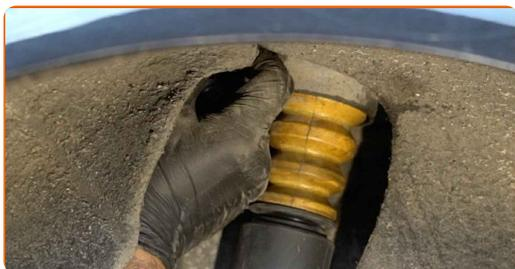
**36** Avvita gli elementi di fissaggio superiori dell'ammortizzatore. Utilizza una chiave a bussola N°16. Usa una chiave a cricchetto.
