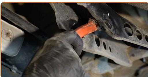
**45** Puntellare il braccio. Usa un cric idraulico per trasmissione. Usa un piede di porco.
