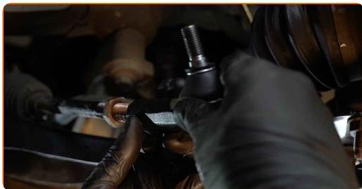
Sostituzione: testine sterzo - SKODA SUPERB Station wagon (3V5). Gli esperti di AUTODOC raccomandano:
