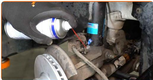
**19** Scollegare la staffa di fissaggio del tubo flessibile del freno. Scollegare la staffa supporto del cablaggio ABS. Utilizza una chiave combinata N°10.
