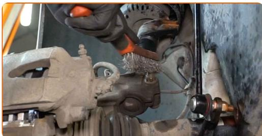
**21** Svita gli elementi di fissaggio che collegano il puntone dell'ammortizzatore al fuso a snodo. Utilizza una chiave a bussola N°18. Usa la chiave XZN n.14. Usa un giramaschi.
