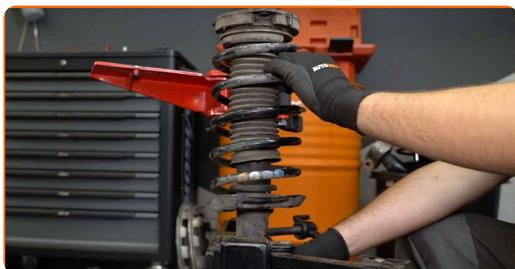
Sostituzione: supporto ammortizzatore - SKODA SUPERB Station wagon (3T5).
