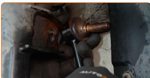
**18** Pulisci gli elementi di fissaggio della staffa del tubo flessibile. Usa una spazzola metallica. Usa lo spray WD-40.
