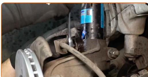
**20** Pulire l'elemento di fissaggio inferiore che collega il puntone di sospensione al fuso a snodo dello sterzo. Usa una spazzola metallica. Usa lo spray WD-40.
