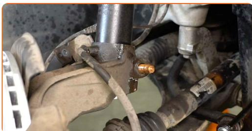
**52** Rimuovi il supporto da sotto il fuso a snodo.
