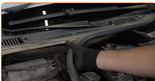
**4** Pulire gli elementi di fissaggio del pannello di copertura del tergicristalli. Usa una spazzola metallica. Usa lo spray WD-40.
