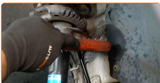
**16** Svita gli elementi di fissaggio che collegano il tirante della barra stabilizzatrice al puntone dell'ammortizzatore. Utilizza una chiave a bussola N°19. Usa una chiave a cricchetto.
