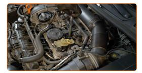
Avvitare le nuove candele e serrarle. Usa la chiave a bussola per candele numero 16. Usa una chiave dinamometrica. Serralo fino allo coppia di torsione di 27 Nm.
