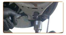
Serra l'elemento di fissaggio che collega il braccio di sospensione allo snodo posteriore. Utilizza una chiave combinata N°18. Utilizza una chiave a bussola N°18. Usa una chiave dinamometrica. Serralo fino allo coppia di torsione di 90 Nm. +90°
