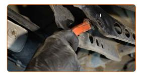
Puntellare il braccio. Usa un cric idraulico per trasmissione. Usa un piede di porco.
