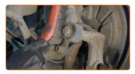
Avvita l'elemento di fissaggio inferiore dell'ammortizzatore. Utilizza una chiave a bussola N°21. Usa un giramaschi.
