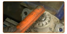
Rimuovere l'elemento di fissaggio dell'asta pistone ammortizzatore. Usa la chiave a bussola per ammortizzatore DDNº6. Utilizza una chiave a bussola N°17. Usa una chiave a cricchetto.
