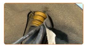
Serrare il perno di fissaggio superiore dell'ammortizzatore. Utilizza una chiave a bussola N°16. Usa una chiave dinamometrica. Serralo fino allo coppia di torsione di 50 Nm. +45°
