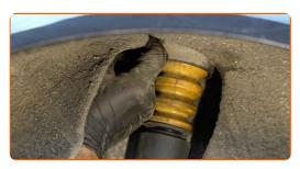
Avvita gli elementi di fissaggio superiori dell'ammortizzatore. Utilizza una chiave a bussola N°16. Usa una chiave a cricchetto.
