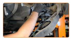
Pulisci le sedi di montaggio e la filettatura del braccio di sospensione. Usa una spazzola metallica. Usa lo spray WD-40.
