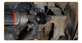
Svita l'elemento di fissaggio superiore dell'ammortizzatore. Utilizza una chiave a bussola N°16. Usa una chiave a cricchetto.
