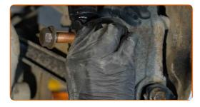
Avvita gli elementi di fissaggio inferiori dell'ammortizzatore. Utilizza una chiave a bussola N°21. Usa una chiave a cricchetto.
