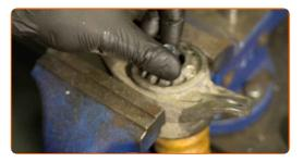
Stringere il dado dell'asta dell'ammortizzatore. Usa la chiave a bussola per ammortizzatore DDNº8. Utilizza una chiave a bussola N°16. Usa una chiave dinamometrica. Serralo fino allo coppia di torsione di 25 Nm.
