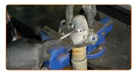
Pulisci l'elemento di fissaggio dell'asta dell'ammortizzatore. Usa una spazzola metallica. Usa lo spray WD-40.
