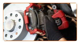
Montare la pinza del freno e fissarla. Utilizza una chiave combinata N°13. Utilizza una chiave combinata N°19. Utilizza una chiave a bussola N°13. Usa una chiave dinamometrica. Serralo fino allo coppia di torsione di 35 Nm.
