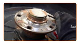
Svitare il supporto di fissaggio del mozzo della ruota. Usa la chiave XZN n.18. Usa un giramaschi.
