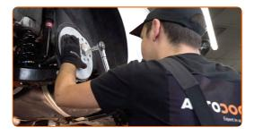
25 Installare il sostegno pinza freno.
