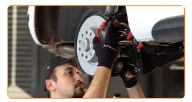
Serrare il sostegno pinza freno. Usa la chiave XZN n.12. Usa una chiave dinamometrica. Serralo fino allo coppia di torsione di 90 Nm.
