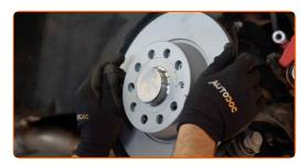
Serrare l'attacco del disco freno. Usa la chiave Torx T30. Usa una chiave dinamometrica. Serralo fino allo coppia di torsione di 4 Nm.
