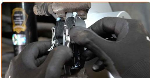
**34** Montare la pinza del freno e fissarla. Utilizza una chiave combinata N°15. Utilizza una chiave a bussola N°13. Usa una chiave dinamometrica. Serralo fino allo coppia di torsione di 35 Nm.
