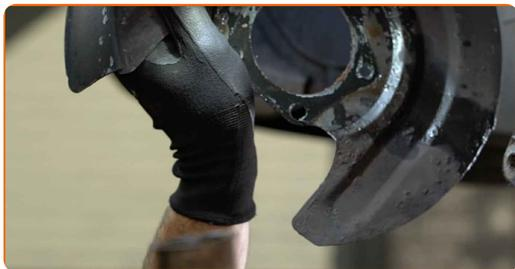
**21** Pulisci la sede di montaggio del cuscinetto del mozzo. Usa una spazzola metallica. Usa lo spray WD-40.
