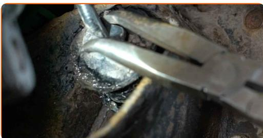
**17** Pulisci l'elemento di fissaggio del mozzo della ruota. Usa una spazzola metallica. Usa lo spray WD-40.
