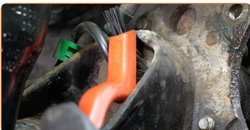
**15** Staccare l'elemento di fissaggio del sensore ABS. Usa un giravite piatto.
