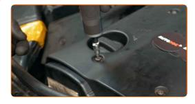
Rimuovere la copertura del motore.
