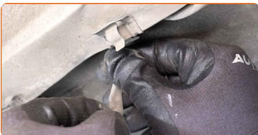
**6** Pulire l'elemento di fissaggio del sensore di ossigeno. Usa una spazzola metallica. Usa lo spray WD-40.
