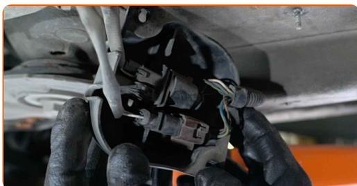
**4** Scollegare il connettore del sensore di ossigeno.
