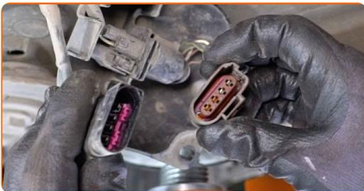
**5** Scollegare il cablaggio del sensore di ossigeno (sonda lamda).
