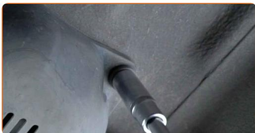
**3** Rimuovere il coperchio dell'alloggiamento della sonda lambda.
