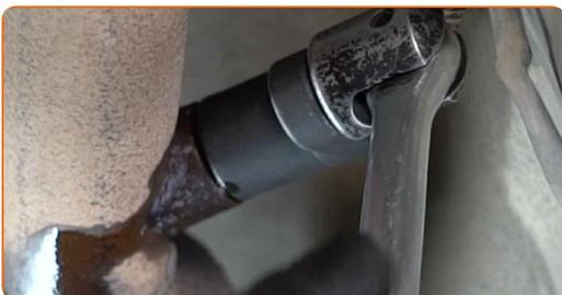
**8** Rimuovere il sensore di ossigeno (sonda lambda).
