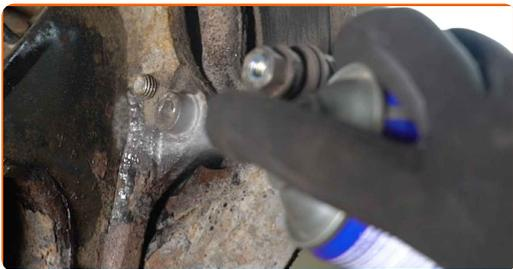
**12** Svitare l'attacco della staffa pinza freno. Usa una chiave HEX N.H8. Usa un giramaschi. Usa una chiave a cricchetto.
