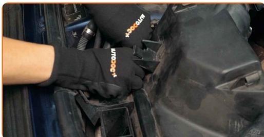
**15** Installare lo scudo termico dell'alloggiamento del filtro dell'aria.
