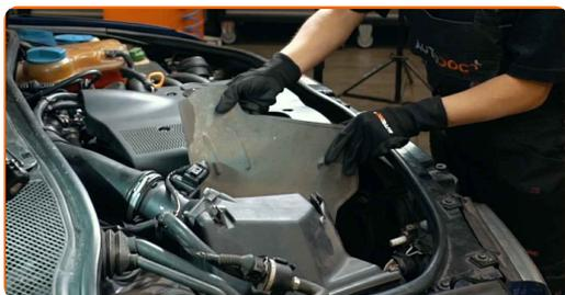
**16** Avvitare gli elementi di fissaggio dello scudo termico dell'alloggiamento del filtro dell'aria. Usa un cacciavite Phillips.
