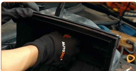
**12** Inserire un nuovo elemento filtrante nell'alloggiamento del filtro. Assicurarsi che i bordi del filtro aderiscano all'alloggiamento.
