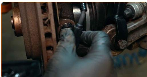
**14** Collegare il cablaggio del sensore ABS.
