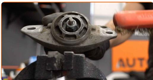
**14** Pulisci l'elemento di fissaggio dell'asta dell'ammortizzatore. Usa una spazzola metallica. Usa lo spray WD-40.
