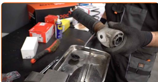
**17** Installa il nuovo supporto, il parapolvere e il tampone dell'ammortizzatore.
