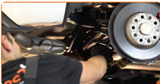
**25** Puntellare il braccio. Usa un cric idraulico per trasmissione.
