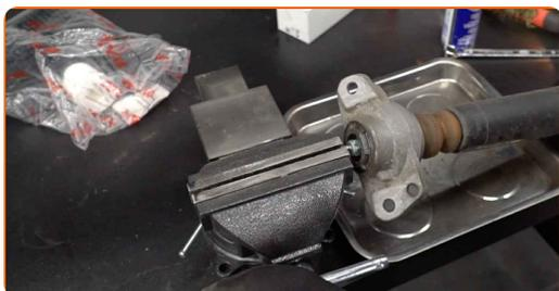
**15** Rimuovere l'elemento di fissaggio dell'asta pistone ammortizzatore. Utilizza una chiave combinata N°14.
