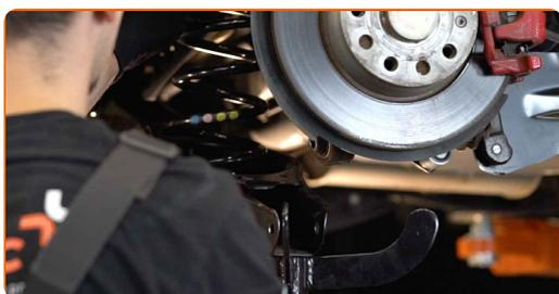
**26** Serra gli elementi di fissaggio che collegano il braccio di sospensione allo snodo posteriore. Utilizza una chiave combinata N°18. Utilizza una chiave a bussola N°18. Usa una chiave dinamometrica. Serralo fino allo coppia di torsione di 90 Nm. +90°
