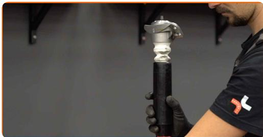
**18** Fissare la sospensione di ammortizzazione. Utilizza una chiave combinata N°14. Utilizza una chiave a bussola N°14. Usa una chiave dinamometrica. Serralo fino allo coppia di torsione di 25 Nm.
