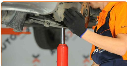
**40** Monta il bullone di fissaggio. Usa un martello.
