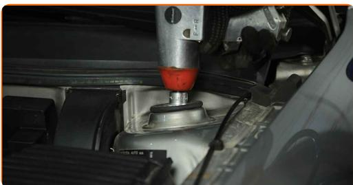
**33** Trattare l'elemento di fissaggio del supporto del puntone di sospensione. Usa il grasso al rame.
