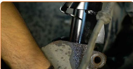
**39** Puntellare il fuso a snodo. Usa un cric idraulico per trasmissione.
