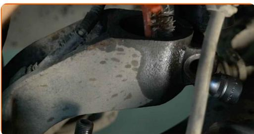
**38** Fissare il supporto di ammortizzazione sul fuso a snodo.
