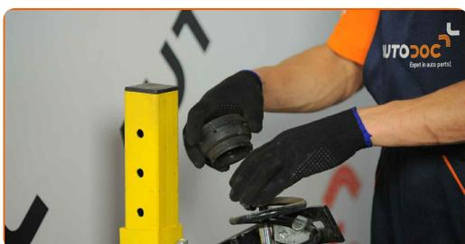
**26** Installare un nuovo elemento di montaggio del supporto di ammortizzazione superiore.
