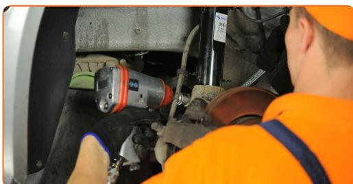
**43** Installa il puntone stabilizzatore trasversale.
