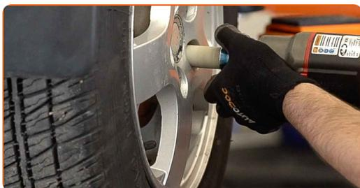
**35** Rimettere il veicolo per terra e, lavorando in ordine incrociato, serrare i bulloni di fissaggio delle ruote. Usa una chiave dinamometrica. Serralo fino allo coppia di torsione di 120 Nm.
