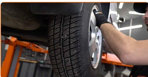
**6** Svita e rimuovi gli elementi di fissaggio del parasassi del passaruota. Usa la chiave Torx T 25.
