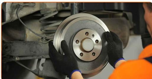
11 Serra gli elementi di fissaggio dei freni a tamburo. Usa la chiave Torx T 30. Usa una chiave dinamometrica. Serralo fino allo coppia di torsione di 4 Nm.
