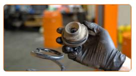
Pulisci le sedi di montaggio della molla elicoidale. Usa una spazzola metallica. Usa lo spray WD-40.
