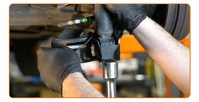
Rimuovi il supporto da sotto la trave dell'asse posteriore.
