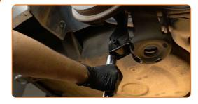
Rimuovi i bulloni di fissaggio. Utilizza una chiave combinata N°16. Utilizza una chiave a bussola N°16. Usa una chiave a cricchetto.
