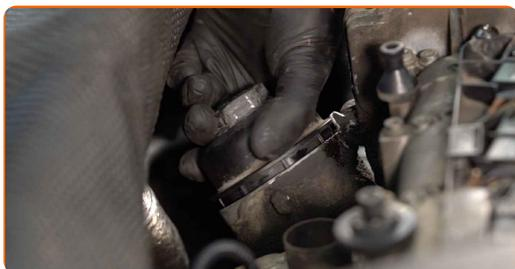
**30** Avvitare il tappo. Utilizza una chiave a bussola N°36. Usa una chiave dinamometrica. Serralo fino allo coppia di torsione di 25 Nm.
