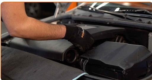
**4** Copri il corpo della farfalla con un panno in microfibra per evitare che la polvere e lo sporco possano penetrare all'interno del sistema.
