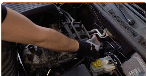
**32** Montare il coperchio motore e fissarlo. Assicurati di sentire un clic indicante che si trova installato saldamente.
