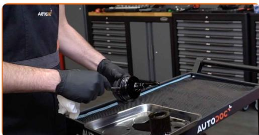
**19** Pulisci il tappo dell'alloggiamento del filtro dell'olio. Usa un detergente spray multiuso.
