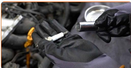
**7** Applica uno strato sottile dello speciale lubrificante antigrippaggio per alte temperature alle filettature delle candele nuove.
