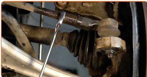
**9** Svitare il dado di attacco del gambo al fuso a snodo. Utilizza una chiave a bussola N°18. Usa un giramaschi.
