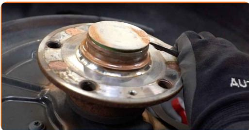
**16** Svitare il supporto di fissaggio del mozzo della ruota. Usa la chiave XZN n.18. Usa un giramaschi.
