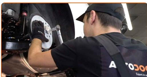
**25** Installare il sostegno pinza freno.
