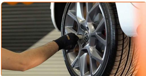
**32** Rimettere il veicolo per terra e, lavorando in ordine incrociato, serrare i bulloni di fissaggio delle ruote. Usa una chiave dinamometrica. Serralo fino allo coppia di torsione di 120 Nm.
