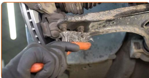
**12** Svita gli elementi di fissaggio che collegano il giunto sferico al braccio di sospensione. Utilizza una chiave a bussola N°16. Usa una chiave a cricchetto.
