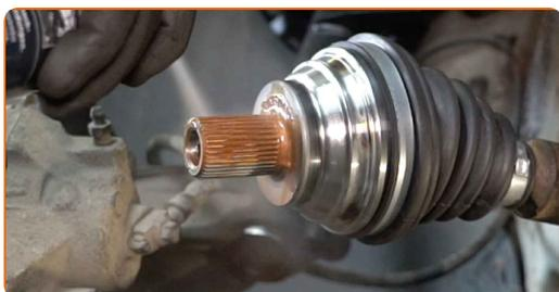
**36** Pulisci la sede di montaggio del giunto sferico. Usa una spazzola metallica. Usa lo spray WD-40.
