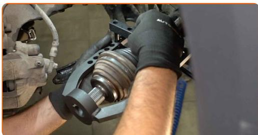
**20** Installa il bullone dell'albero di trasmissione e serralo. Utilizza una chiave a bussola N°27. Usa una chiave a cricchetto.
