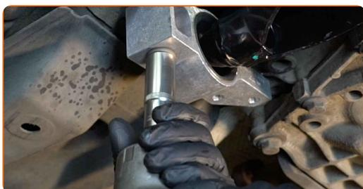
**19** Installa l'elemento di fissaggio posteriore del braccio.
