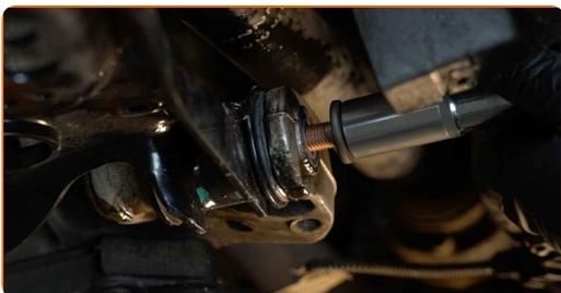
**22** Puntellare il braccio. Usa un cric idraulico per trasmissione.
