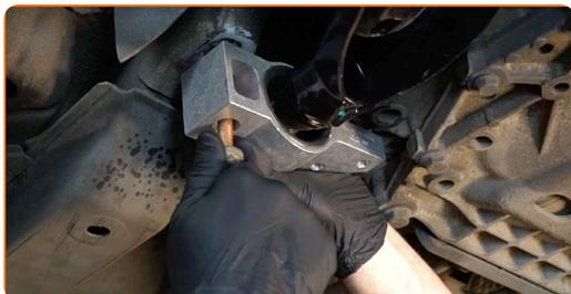
**18** Avvita gli elementi di fissaggio posteriori che collegano il braccio di sospensione alla carrozzeria. Utilizza una chiave combinata N°18. Utilizza una chiave a bussola N°18. Usa una chiave a cricchetto.
