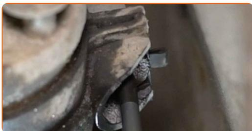
**7** Pulisci gli elementi di fissaggio dei tubi di rifornimento carburante. Usare una spazzola pulente in nylon. Usa un detergente spray multiuso.
