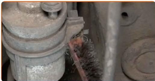
**6** Allentare gli elementi di fissaggio del filtro del carburante. Usa un cacciavite Phillips.
