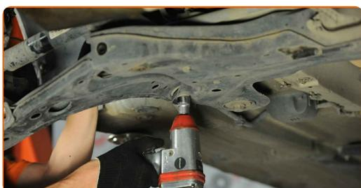
**15** Rimuovi l'elemento di fissaggio posteriore del braccio di sospensione.
