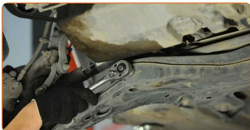
**13** Rimuovi l'elemento di fissaggio frontale del braccio di sospensione.
