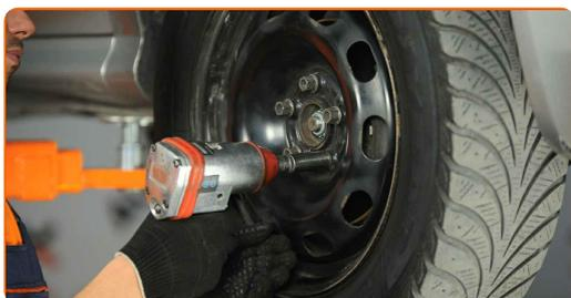
**38** Rimettere il veicolo per terra e, lavorando in ordine incrociato, serrare i bulloni di fissaggio delle ruote. Usa la chiave a bussola per dadi cerchio ruota n.17. Usa una chiave dinamometrica. Serralo fino allo coppia di torsione di 120 Nm.
