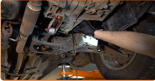
Sostituzione: olio del cambio manuale - SKODA Octavia I Combi (1U5). Gli esperti di AUTODOC raccomandano:
