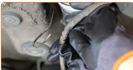
**7** Allentare gli elementi di fissaggio del filtro del carburante. Utilizza una chiave a bussola N°7. Usa una chiave a cricchetto.
