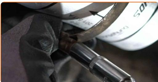
**15** Fissare il cavo del freno di stazionamento.
