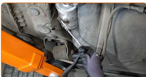
**8** Pulisci gli elementi di fissaggio dei tubi di rifornimento carburante. Usa un detergente spray multiuso.
