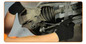
Allenta l'elemento di fissaggio dell'albero di trasmissione. Utilizza una chiave a bussola N°30. Usa una chiave a cricchetto.
