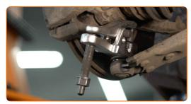
Svita gli elementi di fissaggio che collegano il giunto sferico al braccio di sospensione. Utilizza una chiave a bussola N°13. Usa una chiave a cricchetto.
