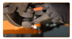
Svitare il perno che fissa il giunto sferico al fuso a snodo. Utilizza una chiave combinata N°18.
