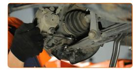
Installare l'elemento che fissa l'asta allo stabilizzatore e serrarlo. Utilizza una chiave a bussola N°16. Usa una chiave dinamometrica. Serralo fino allo coppia di torsione di 15 Nm. +90°
