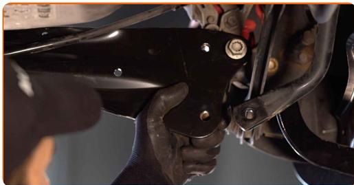
**20** Serra gli elementi di fissaggio che collegano il braccio di sospensione allo snodo posteriore. Utilizza una chiave a bussola N°18. Usa una chiave dinamometrica. Serralo fino alla coppia di torsione di 90 Nm. +90°
