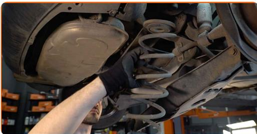
**13** Installa la molla elicoidale insieme ai montanti di gomma nelle sedi di montaggio. Usa un piede di porco.
