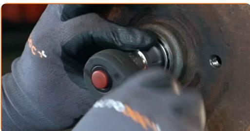
**12** Rimuovi il tamburo dei freni montato con il cuscinetto del mozzo ruota.
