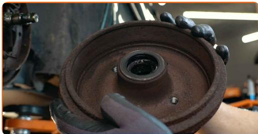
**13** Pulisci la sede di montaggio del cuscinetto del mozzo. Usa un detergente spray multiuso.
