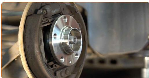
**14** Serrare l'attacco del mozzo. Usa una chiave a bussola 12 punte n. 30. Usa una chiave dinamometrica. Serralo fino allo coppia di torsione di 175 Nm.
