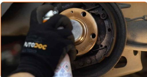
**17** Installare il tamburo del freno e fissarlo.
