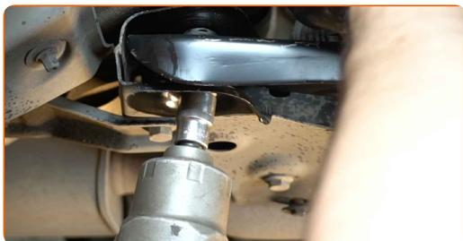
**18** Puntellare il braccio. Usa un cric idraulico per trasmissione.
