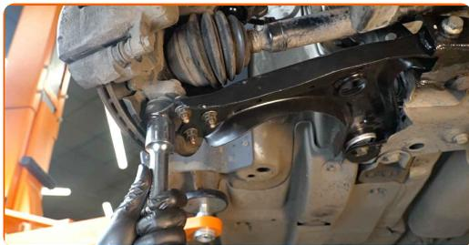
**19** Serra gli elementi di fissaggio anteriori che collegano il braccio di controllo al sottotelaio. Utilizza una chiave a bussola N°18. Usa una chiave dinamometrica. Serralo fino allo coppia di torsione di 70 Nm. +90°
