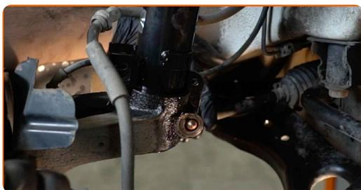
**54** Pulisci le scanalature del giunto omocinetico dell'albero di trasmissione. Usa una spazzola metallica. Usa lo spray WD-40.
