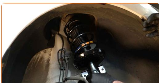
**50** Avvita l'elemento di fissaggio superiore del montante supporto ammortizzazione. Non lo serrare.
