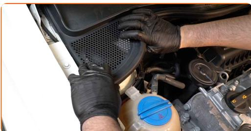
**75** Rimuovi la copertura di protezione del parafrango.
