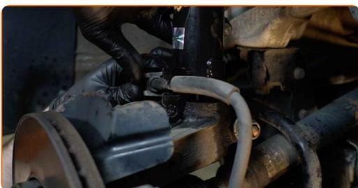
**58** Installa il puntone stabilizzatore trasversale.
