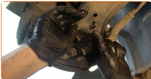
**55** Avvita gli elementi di fissaggio del giunto sferico. Utilizza una chiave a bussola N°16. Usa una chiave a cricchetto.
