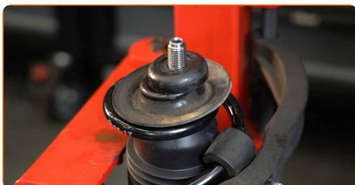
**43** Serrare la vite dell'asta pistone supporto ammortizzazione. Utilizza una chiave a bussola N°21. Usa una chiave HEX N.H6. Usa una chiave dinamometrica. Serralo fino allo coppia di torsione di 60 Nm.
