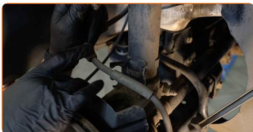
**17** Allenta l'elemento di fissaggio dell'albero di trasmissione. Utilizza una chiave a bussola N°36. Usa un giramaschi.
