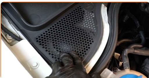
**74** Installa la guarnizione griglia sottoparabrezza.
