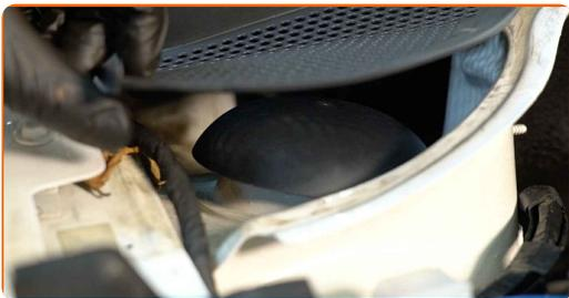
**73** Installa la griglia del sottoparabrezza e fissala.
