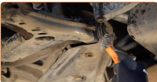
Sostituzione: braccio inferiore anteriore - SKODA Fabia II Hatchback (542). Il consiglio di AUTODOC:
