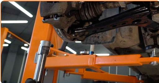
Sostituzione: braccio inferiore anteriore - SKODA Fabia II Hatchback (542). Il consiglio degli esperti di AUTODOC:
