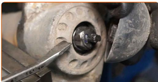
**17** Pulisci l'elemento di fissaggio dell'asta dell'ammortizzatore. Usa una spazzola metallica. Usa lo spray WD-40.
