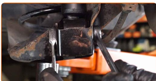
**30** Per serrare correttamente i fissaggi, è necessario sollevare i componenti della sospensione fino a raggiungere la relativa posizione di lavoro. Usa un cric idraulico per trasmissione.
