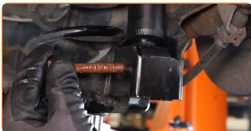
**29** Avvita gli elementi di fissaggio inferiori dell'ammortizzatore. Utilizza una chiave combinata N°16 (2 pezzi). Usa una chiave a cricchetto.
