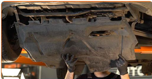
**16** Avvita gli elementi di fissaggio dell'insonorizzazione inferiore. Utilizza una chiave a bussola N°12. Usa un cacciavite Phillips.
