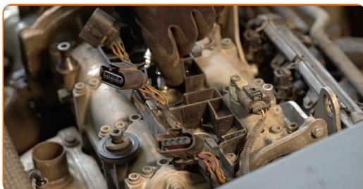
**14** Avvitare le nuove candele e serrarle. Usa la chiave a bussola per candele numero 16. Usa una chiave dinamometrica. Serralo fino allo coppia di torsione di 25 Nm.
