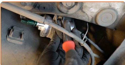
**14** Collegare le linee di alimentazione del carburante al filtro carburante.
