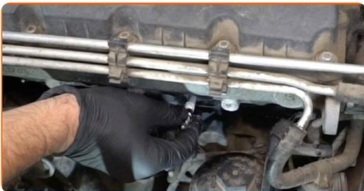
**11** Stringere le candele. Usa la chiave a bussola per candele numero 10. Usa una chiave dinamometrica. Serralo fino allo coppia di torsione di 15 Nm.
