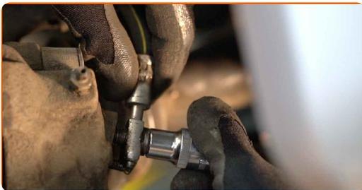
**12** Svita gli elementi di fissaggio che collegano il tubo flessibile del freno alla tubatura del circuito dei freni. Utilizza una chiave combinata N°11.
