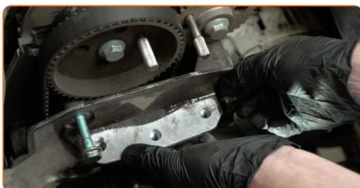
**37** Rimuovi il supporto del motore.
