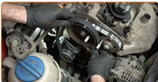
Sostituzione: pompa acqua + kit cinghia distribuzione - SKODA Fabia I Combi (6Y5). AUTODOC raccomanda:
