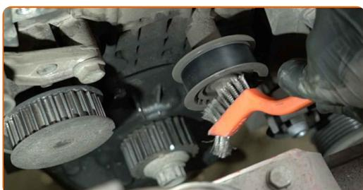
**45** Svitare il dispositivo di fissaggio della puleggia guidacinghia della cinghia di distribuzione. Utilizza una chiave a bussola N°15. Usa una chiave a cricchetto.
