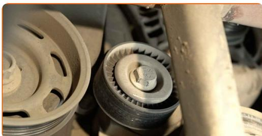
**19** Svitare il dispositivo di fissaggio del rullo tenditore della cinghia Poly-V. Utilizza una chiave combinata N°16.
