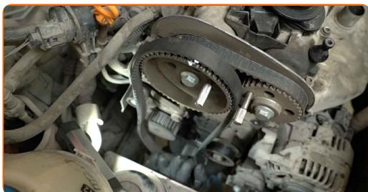
**44** Pulire l'elemento di fissaggio della puleggia guidacinghia della cinghia di distribuzione. Usa una spazzola metallica. Usa lo spray WD-40.
