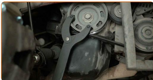
**99** Stringere il dispositivo di fissaggio della puleggia dell'albero a gomiti. Usa la chiave a bussola 12 punte n.21. Usa una chiave dinamometrica. Serralo fino alla coppia di torsione di 90 Nm. +90°
