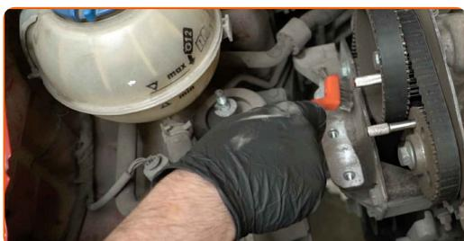
**35** Svita gli elementi di fissaggio del supporto del motore. Utilizza una chiave a bussola N°16. Usa una chiave a cricchetto.
