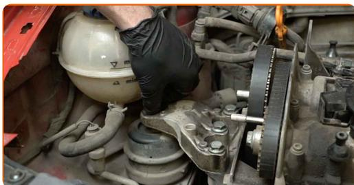
**34** Pulisci gli elementi di fissaggio del supporto del motore. Usa una spazzola metallica. Usa lo spray WD-40.
