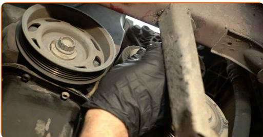
**95** Avvitare il dispositivo di fissaggio del rullo tenditore della cinghia Poly-V Utilizza una chiave combinata N°16.
