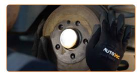
Serra gli elementi di fissaggio dei freni a tamburo. Usa un cacciavite Phillips. Usa una chiave dinamometrica. Serralo fino allo coppia di torsione di 4 Nm.
