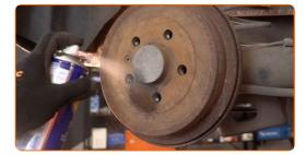
Svitare il supporto di fissaggio del tamburo freno. Usa un cacciavite Phillips.
