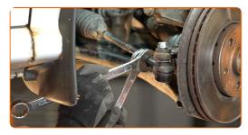
Serra il bullone di fissaggio che collega la testina tirante al fuso a snodo. Utilizza una chiave a bussola N°19. Usa una chiave dinamometrica. Serralo fino allo coppia di torsione di 20 Nm. +90°
