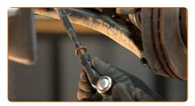
Sostituzione: testine sterzo - SKODA FABIA (6Y2). Gli esperti di AUTODOC raccomandano:
