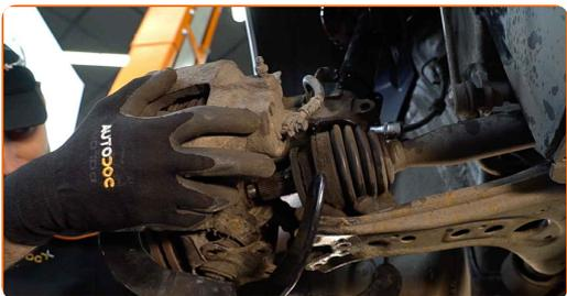
**49** Rimuovi il supporto da sotto il fuso a snodo.
