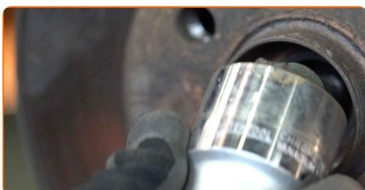
**22** Tratta con del prodotto la sede di montaggio dell'albero di trasmissione del fuso a snodo. Usa lo spray WD-40.
