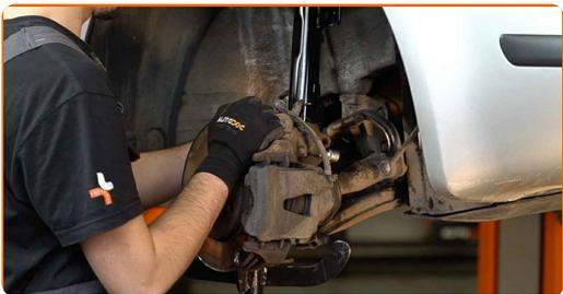
**46** Puntellare il fuso a snodo. Usa un cric idraulico per trasmissione.
