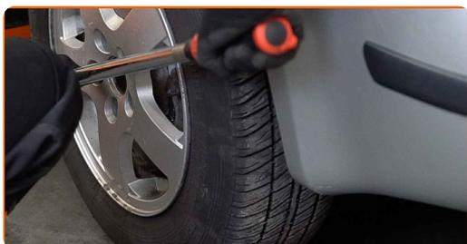
**64** Rimuovi la copertura di protezione del parafrango.
