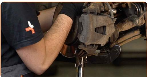
**47** Pulisci le scanalature del giunto omocinetico dell'albero di trasmissione. Usa lo spray WD-40.
