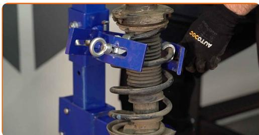
**30** Pulisci l'asta dell'ammortizzatore. Usa una spazzola metallica. Usa lo spray WD-40.
