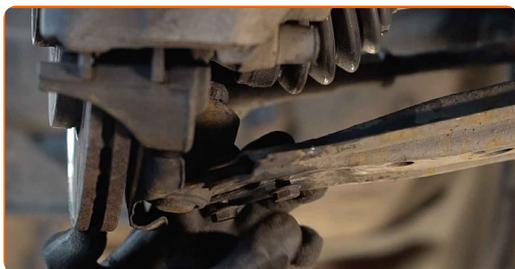
**53** Stringi gli elementi di fissaggio del giunto sferico. Utilizza una chiave a bussola N°13. Usa una chiave dinamometrica. Serralo fino allo coppia di torsione di 20 Nm. +90°
