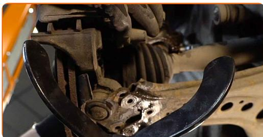
**21** Svita gli elementi di fissaggio che collegano l'albero di trasmissione al mozzo della ruota. Usa una chiave a bussola 12 punte n. 36.
