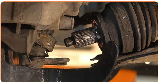
**48** Montare l'albero di trasmissione.
